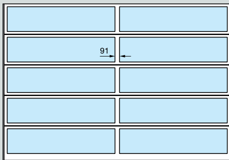
Vyhotovenie brány so šírkou nad 3330 mm so zvislou priečfou (91 mm)
