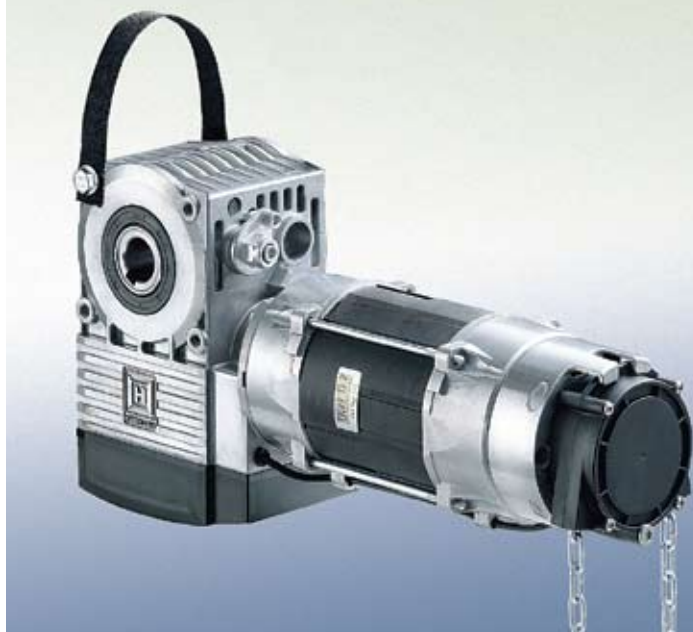
Hriadel'ový pohon WA 400 k pripojeniu prírubou s ručnou núdzovou reťazou (ovládateľný zo zeme)
