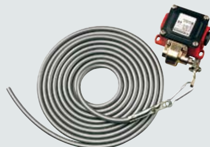
Ťahový spínač s ťažným lanom z plastu s možnosťou vodorovnej alebo zvislej montáže, schránka z pretlačovanej hliníkovej liatiny, IP 65. Dĺžka lana: 4 m.
