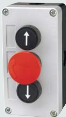
Ovládacie tlačidlo s tromi funkciami „Otvoriť-Núdzové vypnutie-Zavrieť“. Plastová schránka, IP 65.
