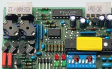
Vyhodnocovač indukčných slučiek Zasúvacia karta s 1 alebo 2 kanálmi. Vhodná pre dve oddelené indukčné slučky. Dodáva sa bez slučkového káblu.
